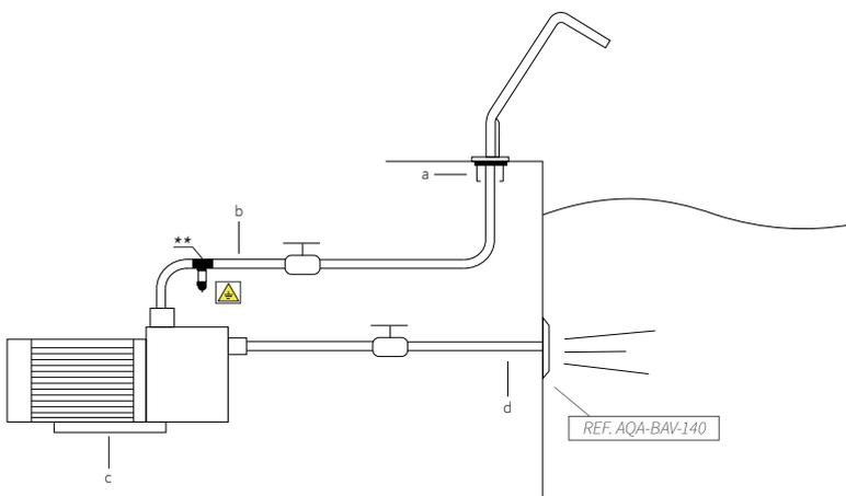
1) Conectar la toma de agua en el anclaje con manguito de 1 1/2" hembra.
