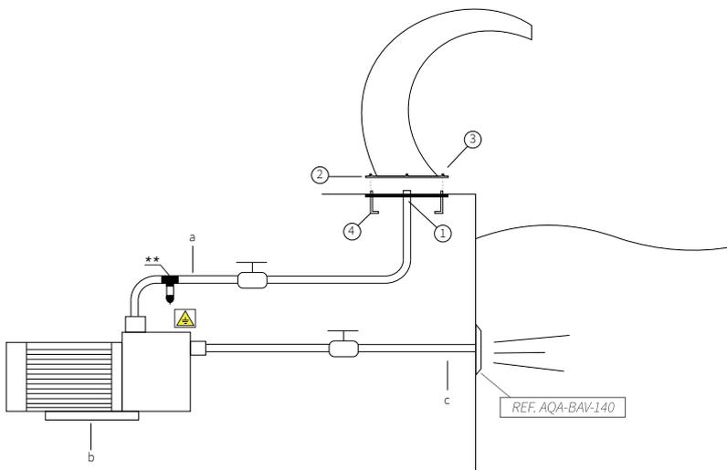
\*\*AQA recommandé d'installer un POOL PROTECTOR, pour éviter la corrosion des éléments en acier inoxydable présents dans la piscine.
