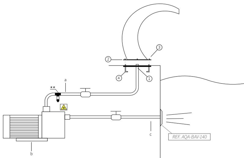
\*\*AQA recomienda instalar un POOL PROTECTOR, para evitar la corrosión de los elementos de acero inoxidable existentes en la piscina.
