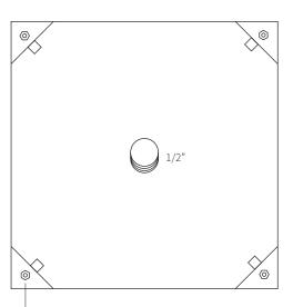
Fixation opcionnelle avec écrous M-6 pour support extensible ou câble de sécurité.
